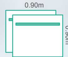
(2) Campos de 0.90m x 0.90m con tira adhesiva
