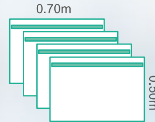
(4) Campos de 0.70m x 0.50m con tira adhesiva
